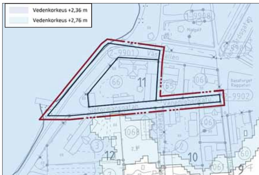
Kuva 12. Ennustettu 1/100 a meritulva ja aaltoiluarakorotus vuonna 2100. Vedenkorkeus on interpoloitu Ilmatieteenlaitoksen (2014) tulvaennusteesta Helsinkiin ja Hankoon.
